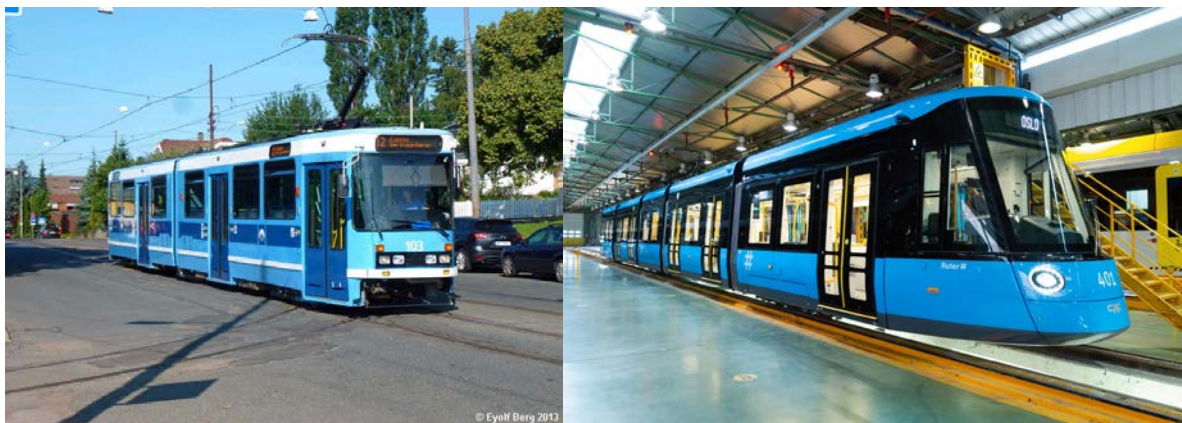
Figur 5.3: Utforming av front på trikk type SL79 (venstre) og SL18 (høyre)
