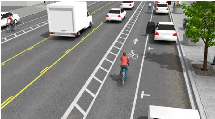
Figur 3.2: Buffered bicycle lane i USA, prinsippskisse fra NACTO 5 .
