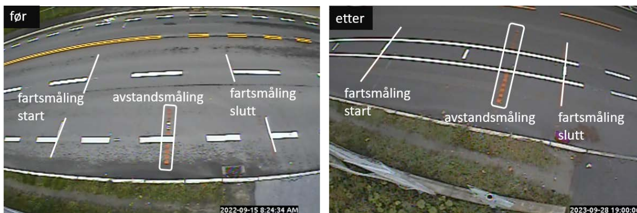
Figur 6.6: Markeringer for måling av sideavstand og hastighet (venstre - før situasjon; høyre - etter situasjon).
