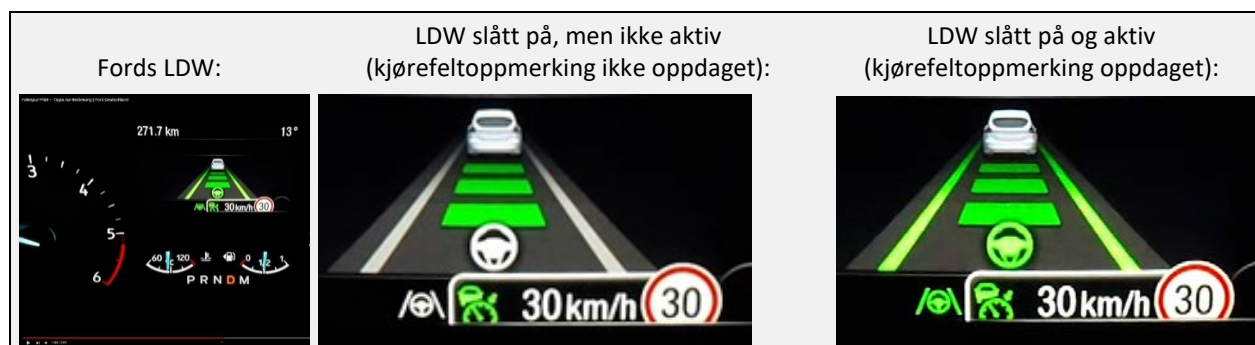
Figur 3: LDW-system av Ford på dashbordet (venstre) med visning når vegoppmerking ikke er oppdaget (midten) og oppdaget (høyre).
