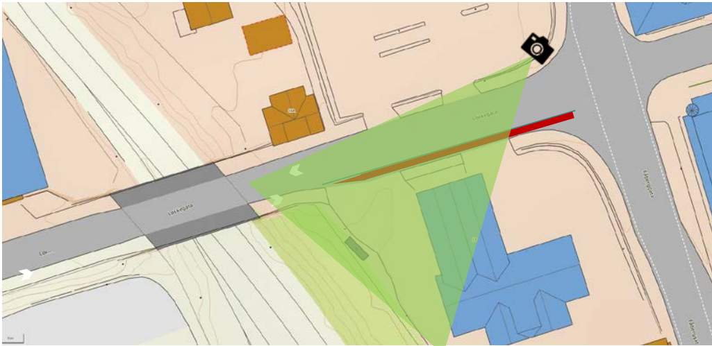
Figur 22: Løkkegata i Lillehammer. Angivelse av kameraplassering, samt oppmerking med sharrows i kjørebanelen. Det røde feltet er en kort strekning med sykkelfelt. Den grønne linja markerer forsøksstrekningen.
