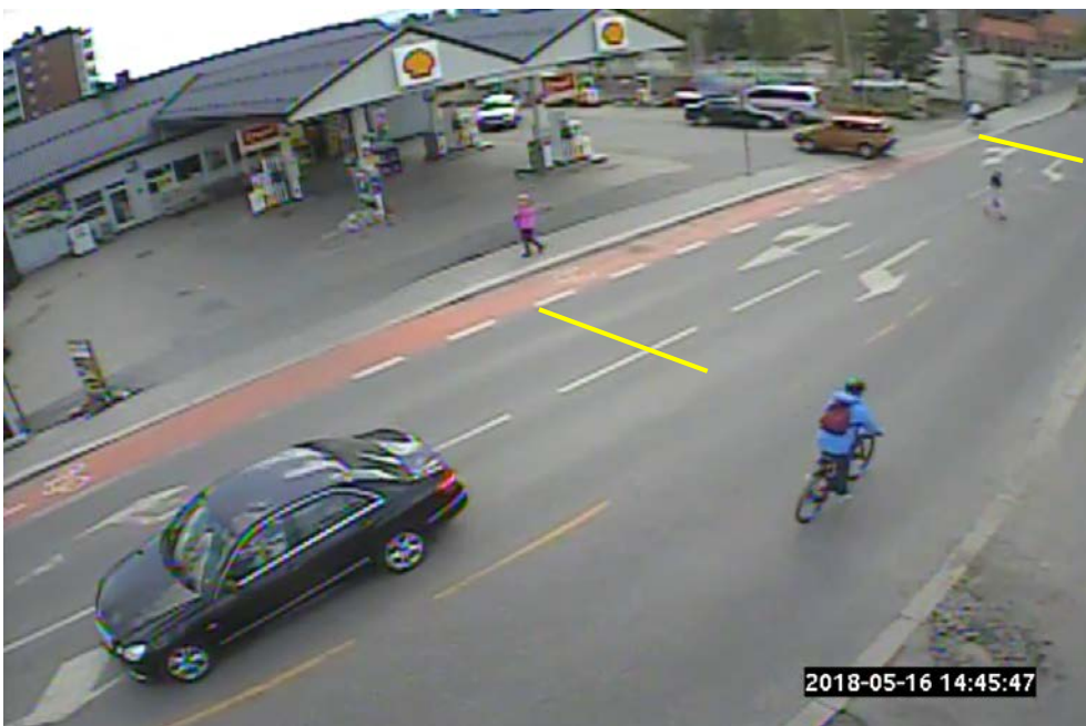
Figur 23: Bilde fra videokameraet med plassering vest (for oppmerking med sharrows). Gule linjer angir referanselinjer for måling av syklistenes fart. Linjene ble lagt på skjermen under avlesning og var ikke anmerket i veibanen.
