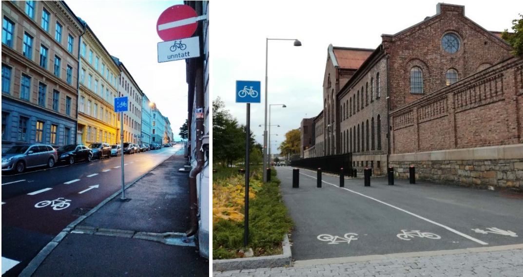
Figur 16: Til venstre: Eksempel på bruk av underskilt som tillater sykling mot enveisregulert gate. Det er også etablert sykkelfelt i mostroms kjøreretningen. Til høyre: Sykkelvennlige kjoretøysperrer på Akershusstranda. Foto: Oddrun Helen Hagen
