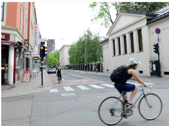
Figur 17: Sykkelboks i lysregulert kryss. Fra krysset mellom Universitetsgata og Kristian IV's gate. Foto: Oddrun Helen Hagen
