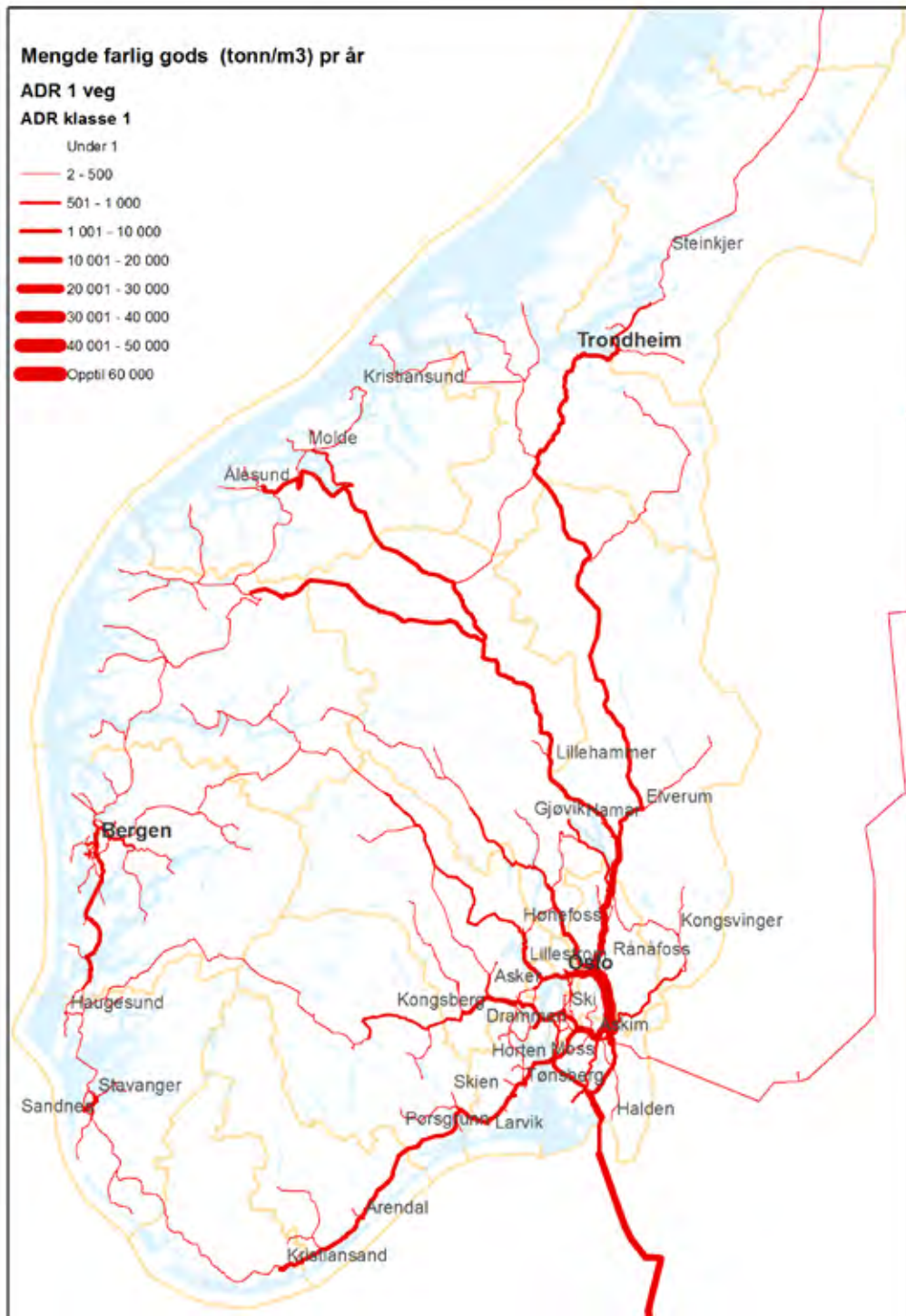
Figur 6.6 Mengde av fareklasse 1 (Eksplorative stoffer og gjenstander) transportert på ulike vegstrekninger i 2012. Sør-Norge. Tonn/m 3 pr år. Total mengde utgjør ca 73 tusen tonn/m 3 . Kilde: Kartlegging gjennomført av TØI og DSB.
