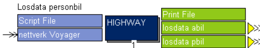
Figur 2.11. Flytskjema for modulen med navn LOS-data bil.
