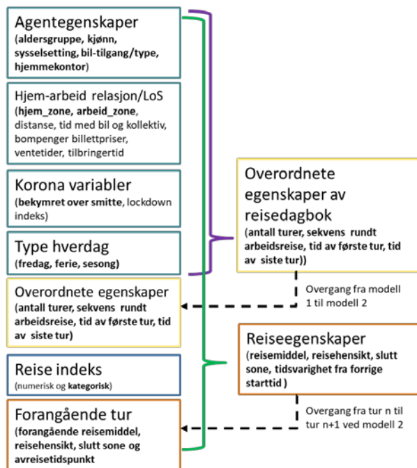
Figur S2: Inndata- og utdata-variabler for de to nevrale nettverksmodellene. De lilla klammene indikerer modell 1, og den grønne klammen indikerer modell 2. Kategoriske variabler er i fet skrift.
