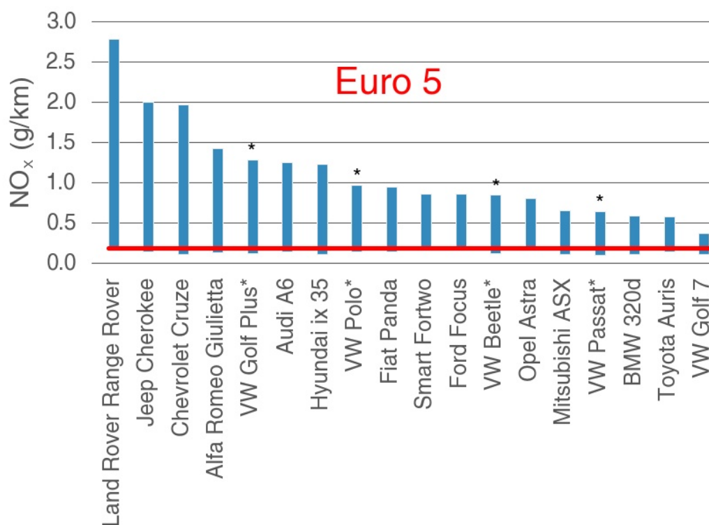
Figur S 4: Oversikt over resultater av laboratoriemålinger og målinger på veg i en definert kjøresyklus av Euro 5-personbiler, gjennomført av tyske KBA. Kjøretøyene er rangert etter høyest utslipp av NO x . Den nederste enden av søylen viser resultatet fra måling i typegodkjenningscyklusen (NEDC) på laboratoriet, den øverste enden tilsvarer den høyeste verdien målt i en mer representativ kjøresyklus for virkelig trafikk. Kjøretøyene markert med '*' er Volkswagen biler med "avgassmanipulerende programvare". De røde linjene markerer grenseverdien i typegodkjenningen. Data fra KBA (BMVI 2016).
