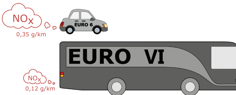
Figur S1: Nye tunge kjøretøy med Euro VI godkjente dieselmotorer har meget lave utslipp av alle lokalt forurensende avgasskomponenter. Høye utslipp av \text{NO}_x fra nye personbiler med Euro 6 dieselmotorer er fortsatt en utfordring under krevende bykjøring. De viste avgassutslippene er typiske for krevende bykjøring med personbiler og tilsvarende for bybusser.
