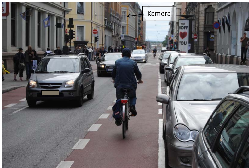
Figur 3.1 Bilde fra Skippergata som viser sykling mot enveisregulert trafikk samt plassering av videokamera
